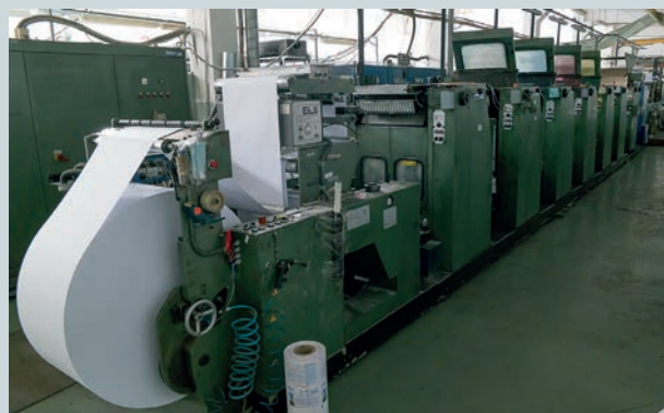
На предприятии работают пять узкоролонных офсетных машин различной конфигурации для печати общей, неменяющейся части квитанций
